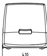
La seduta **S40** appositamente studiata per la scuola primaria e secondaria, è realizzata in polipropilene, su telaio metallico a 4 gambe in tubolare di diametro 22 mm, design moderno, robusta e maneggevole grazie al foro centrale. Impilabile
