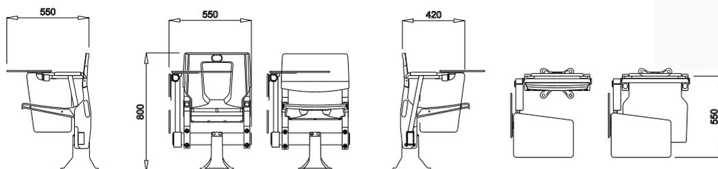
La Versione **“CON BRACCIOLI PIEGHEVOLI”** è la soluzione ideale per il cliente che con spazi ristretti non vuole rinunciare alla comodità dei braccioli. Grazie ad uno speciale meccanismo fissato alle fiancate laterali della struttura portante, il bracciolo in polipropilene è in grado di piegarsi di oltre 100°.
