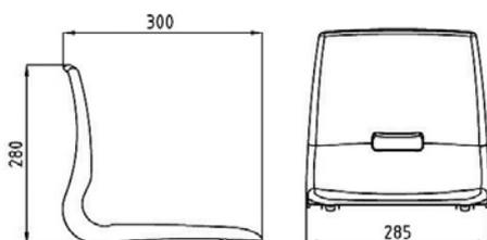
La seduta **S20** è stata appositamente studiata per la scuola dell'infanzia, è realizzata in polipropilene, su telaio metallico a 4 gambe in tubolare di diametro 22 mm, design moderno, robusta e maneggevole grazie al foro centrale e impilabile.
