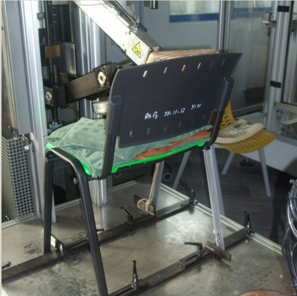
prova di carico statico
