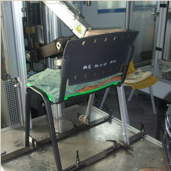
Test de charge statique
